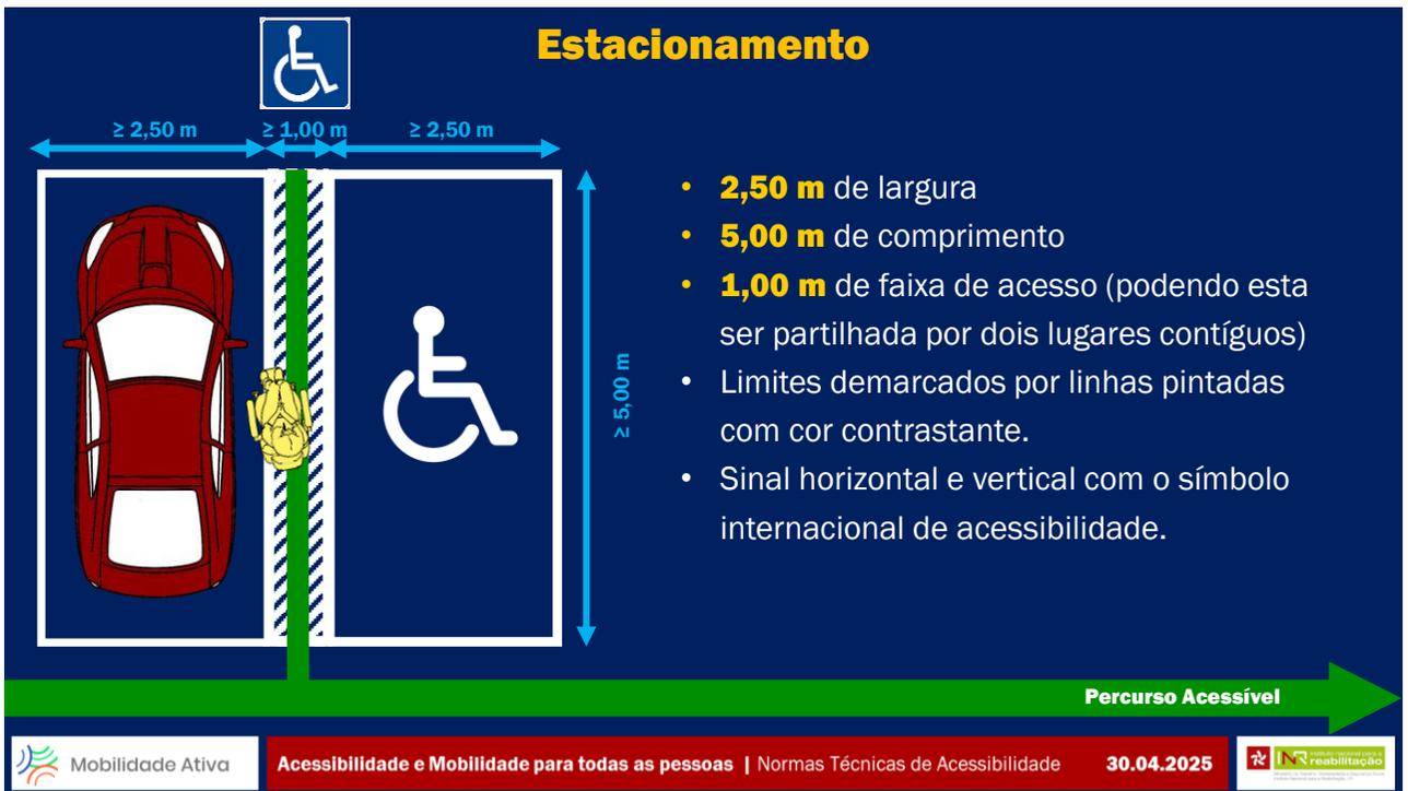
$\geq 2,50 \text{ m}$     $\geq 1,00 \text{ m}$     $\geq 2,50 \text{ m}$
